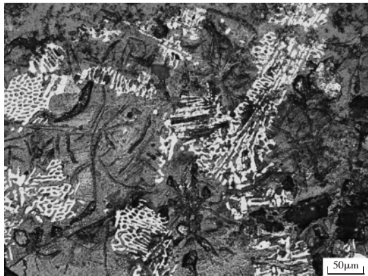
图一二 甘肃礼县出土春秋时期铁鼎的金相组织照片
