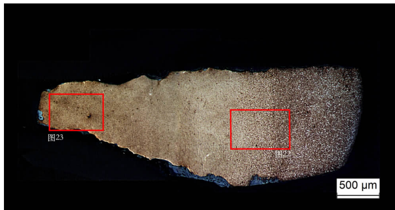
21 铁刀 41030(T19③:3) 横截面金相组织,左侧为刃部,右侧为刀背,由左侧到右侧有含碳量 降低的过渡现象
